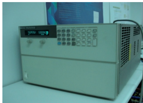
Fig. 3: Fuente de perturbaciones programable como sistema generador.
